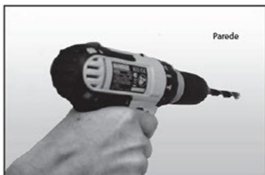
**3** EXECUTE A FURAÇÃO NA PAREDE USANDO BROCA COM DIÂMETRO DE 8 mm.
