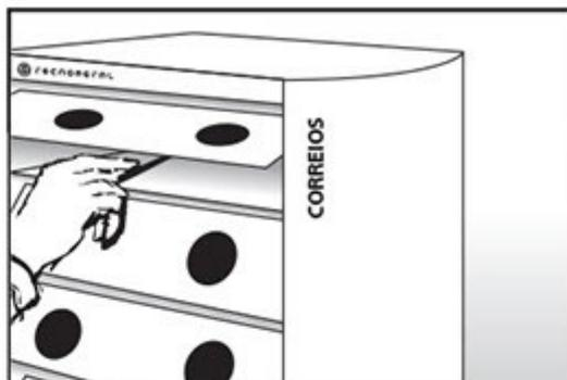
**2** USE A FURAÇÃO JÁ EXISTENTE NAS CAIXAS PARA MARCAR A POSIÇÃO NA PAREDE.
